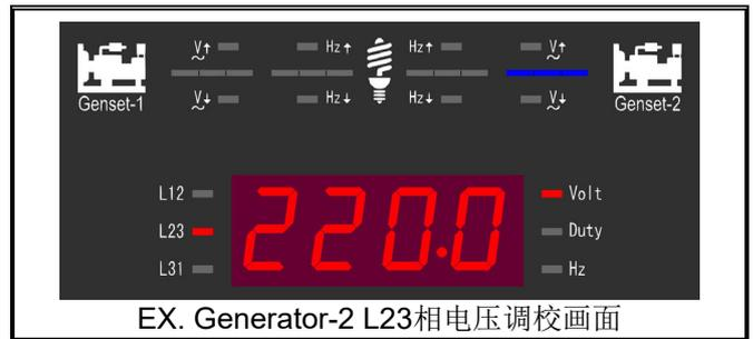
步骤4: 使用准确的三用电表读取欲校正的相位电压值。
